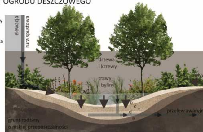
SCHEMAT OGRÓDU DESZCZOWEGO
