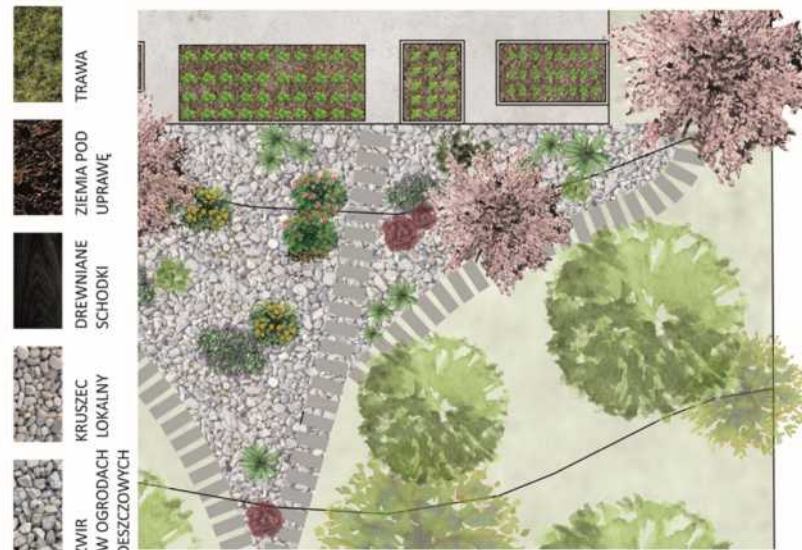
SCHEMAT OGRÓDU DESZCZOWEGO
